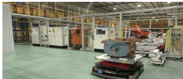
▲图 2-2 智能视觉引导的柔性装夹
