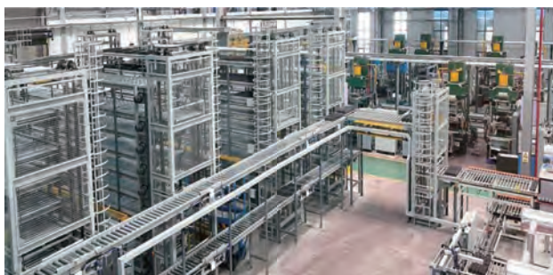
▲图 2-3 车间智能立体库
