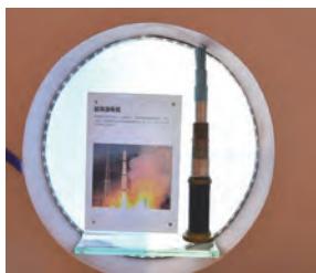
▲图 1-2 航空航天用柔软轻型超高温电缆
