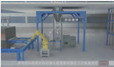
▲图 2-1 自动装钵流程模拟仿真
