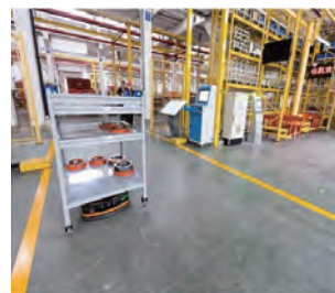
▲图 8 AGV 运输及装配零部件立体库（仓储精准配送）
