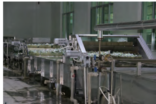
▲图 2-2 自动杀菌流水线
