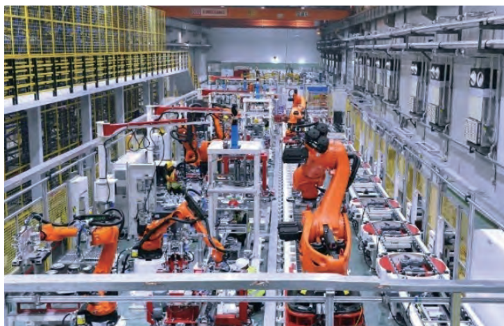
▲图 1-1 城轨及标动牵引电机智能装配线
