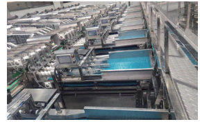
▲图 2-7 自动上瓶、装瓶、称重一体机
