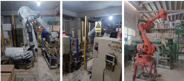
▲ 图 2-1 练泥机器人码垛、拆垛
