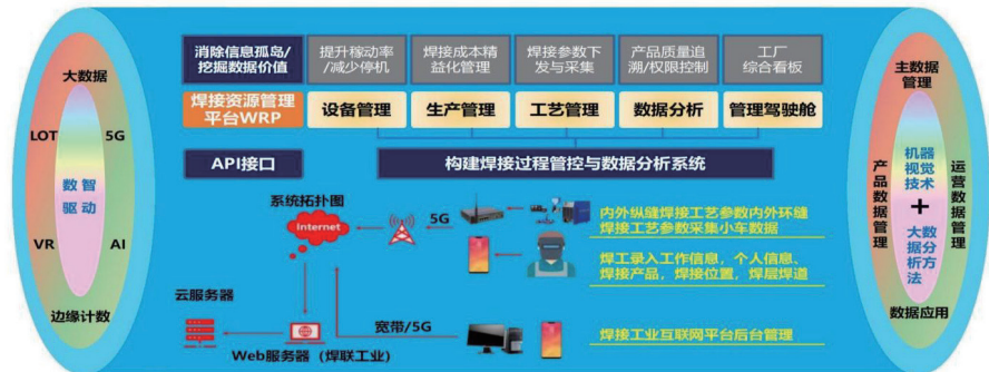
▲图 1-5 企业形成的独有的风电塔架基于机器视觉的数字化质量管理模式
