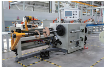
▲图 2-3 具备数采功能的绕线设备
