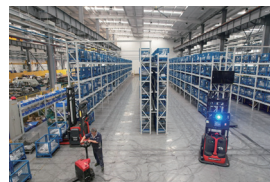
▲图 2-2 智能仓储系统 AGV 小车
