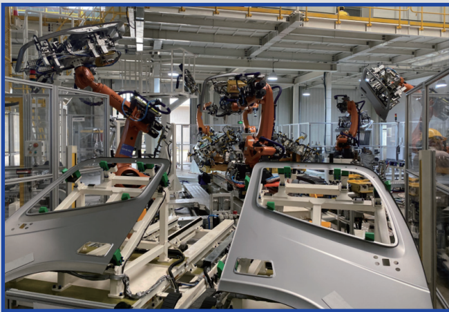
图 1: 车门焊接滚边区
