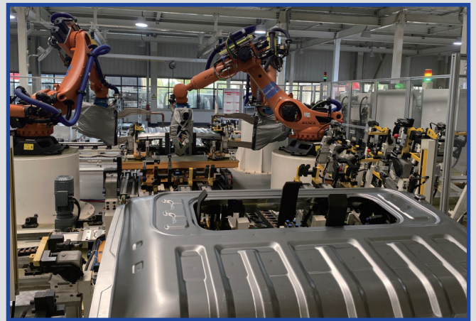
图 2: 后围自动焊接区
