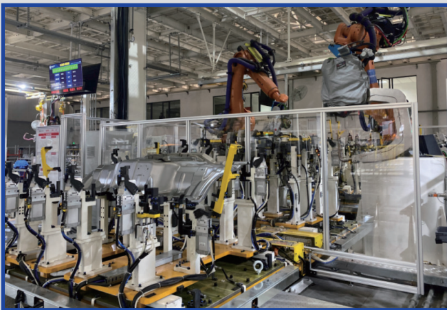
图 3: 地板面板焊接区
