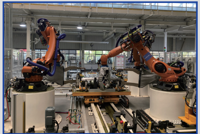
图 4: 顶盖总成焊接区
